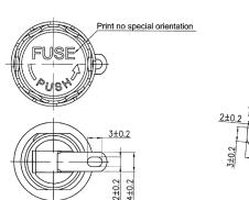
Dimensions : Millimetres Tolerances : ±0.3mm
