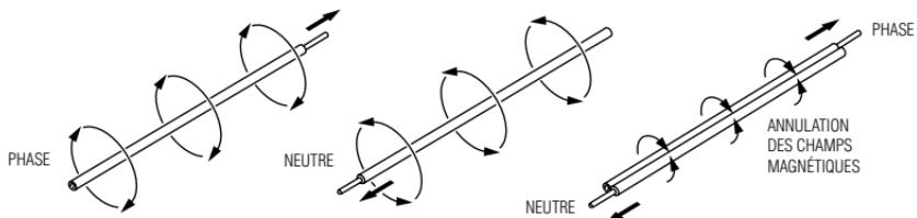
Pour éviter l'effet d'annulation des champs magnétiques opposés, et pour optimiser le signal transmis, le conducteur à suivre doit être séparé du conducteur de retour en utilisant un trajet de retour détourné.
