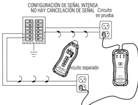
Si no está seguro de que el trayecto de retorno remoto sea correcto, use un multímetro para medir la resistencia entre el neutro del circuito y el trayecto de retorno remoto. Si es  $>100\Omega$ , debe seleccionar un trayecto de retorno diferente.
