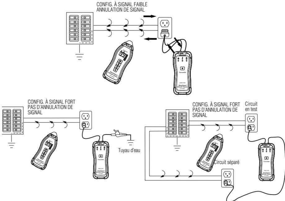
Si vous n'êtes pas sûr que le trajet de retour choisi est bon, utilisez un multimètre pour mesurer la résistance entre le circuit de neutre et le trajet de retour détourné. Si cela fait plus de  $100\ \Omega$ , il faut chercher un autre trajet de retour détourné.
