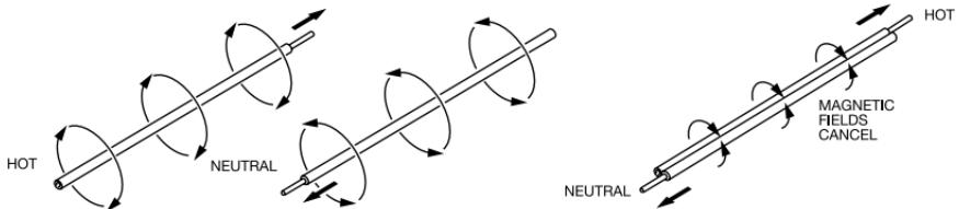
Para evitar el efecto de cancelación de los campos magnéticos opuestos y optimizar la señal transmitida, el conductor a rastrear debe separarse del de retorno utilizando un trayecto de retorno remoto.
