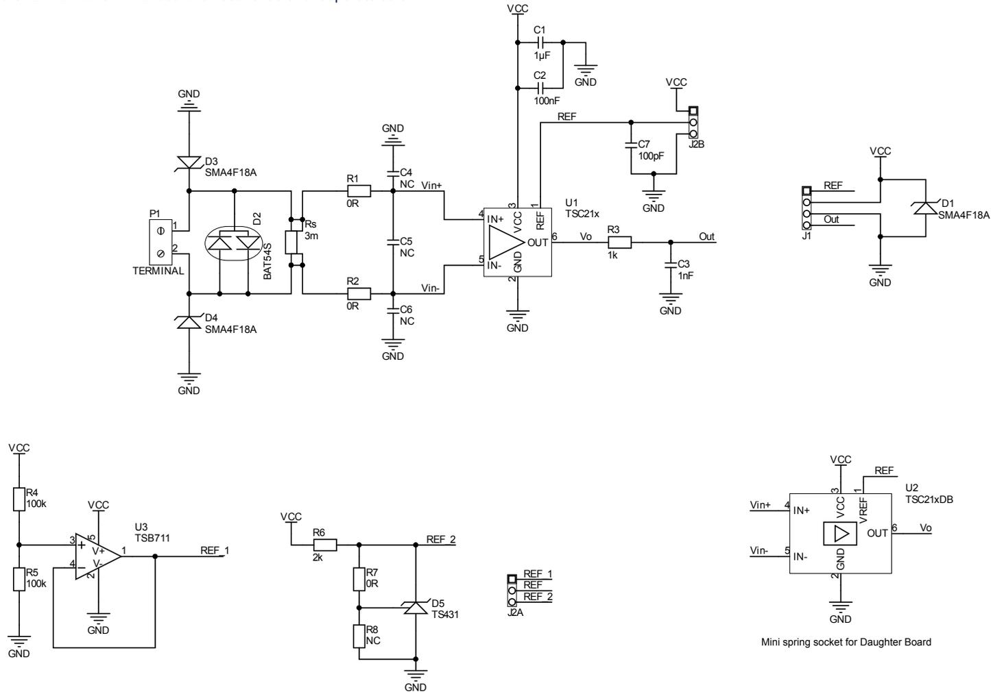
**Figure 2. STEVAL-AETKT2V1 daughterboard (STEVAL-AET012V1B) circuit schematic**
