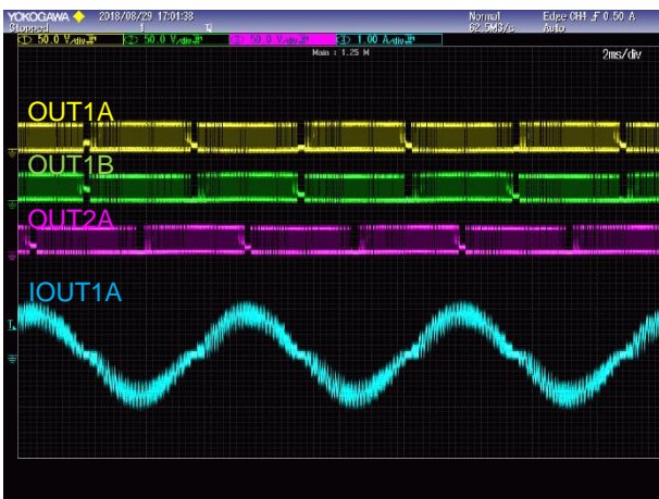
Figure 18. 1/8 STEP ( CLK : 4800Hz )
