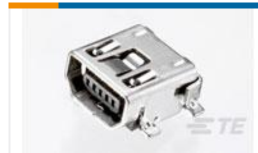
TE Part #1-1734328-2 Mini USB AB R/A,Rcpt,SMT,T&R, 0.6 mm
