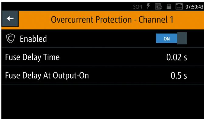
L'utilisateur peut régler les limites de sécurité afin de restreindre la plage d'ajustement de l'instrument et d'empêcher qu'un dispositif sous test soit endommagé accidentellement par l'adoption de mauvais réglages.
