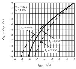
Fig. 13.2.10 (V<sub>OH</sub> - V<sub>CC</sub>) - I<sub>OPH</sub>
