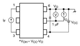
Fig. 13.1.3 V<sub>OH</sub> Test Circuit
