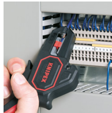
狭い場所での剥ぎ取り
