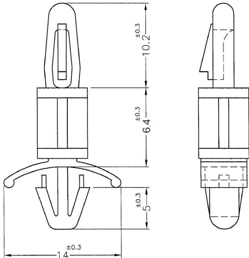
HOLE IN CHASSIS:  $\phi 4.8\sim\phi 5.0\text{mm}$
