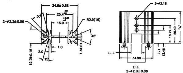
Guide pin diameter: 2.3mm ±0.06mm
