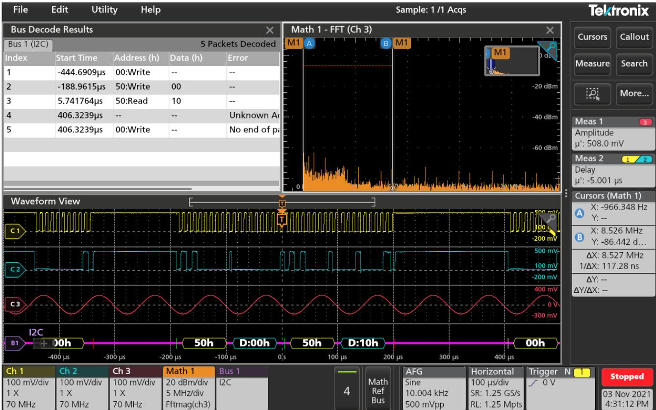
Mit der individuell anpassbaren Benutzeroberfläche können Sie gleichzeitig analoge Kanäle, dekodierte serielle Bussignalförmungen, Ergebnistabellen, Messergebnisse, mathematische FFT-Darstellungen und Cursor-Auslesungen sowie die Setup-Informationen für jeden Eingang anzeigen.
