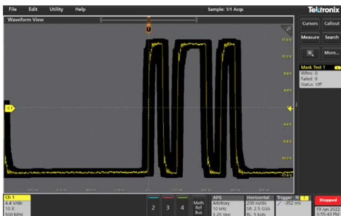
Prueba de máscara de límite basada en la señal de referencia dorada
