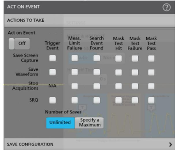
Il est possible d'automatiser un oscilloscope à l'aide de la fonction Agir sur événement lorsqu'un événement donné se produit
