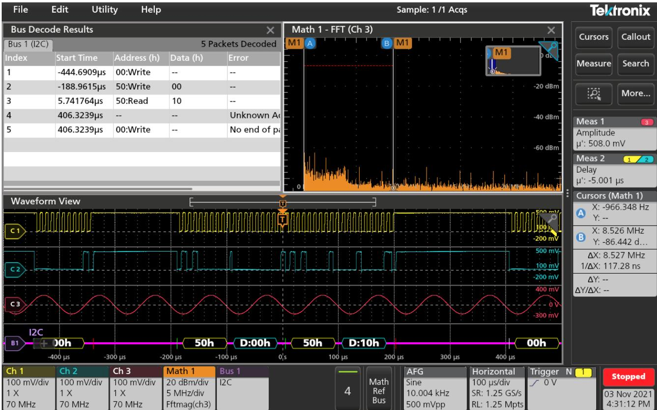
Affichez simultanément les voies analogiques, le signal du bus série décodé, le tableau des résultats, les résultats des mesures, le tracé FFT mathématique et les affichages de curseur, ainsi que les informations de configuration pour chaque entrée grâce à l'interface utilisateur hautement personnalisable.
