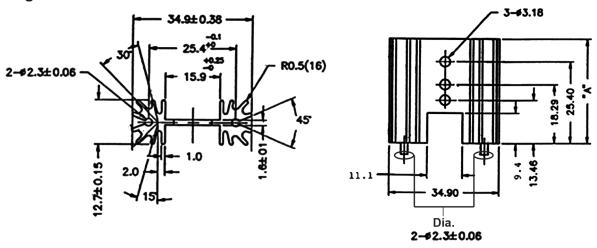
Guide pin diameter: 2.3mm ±0.06mm
