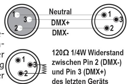
Bei längeren Kabelwegen ist es empfehlenswert, einen Endwiderstand zwischen Pin 2 und 3 zu löten, um Signalfehler zu vermeiden.
