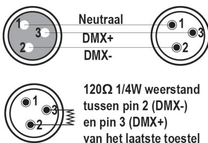
120Ω 1/4W weerstand tussen pin 2 (DMX-) en pin 3 (DMX+) van het laatste toestel
