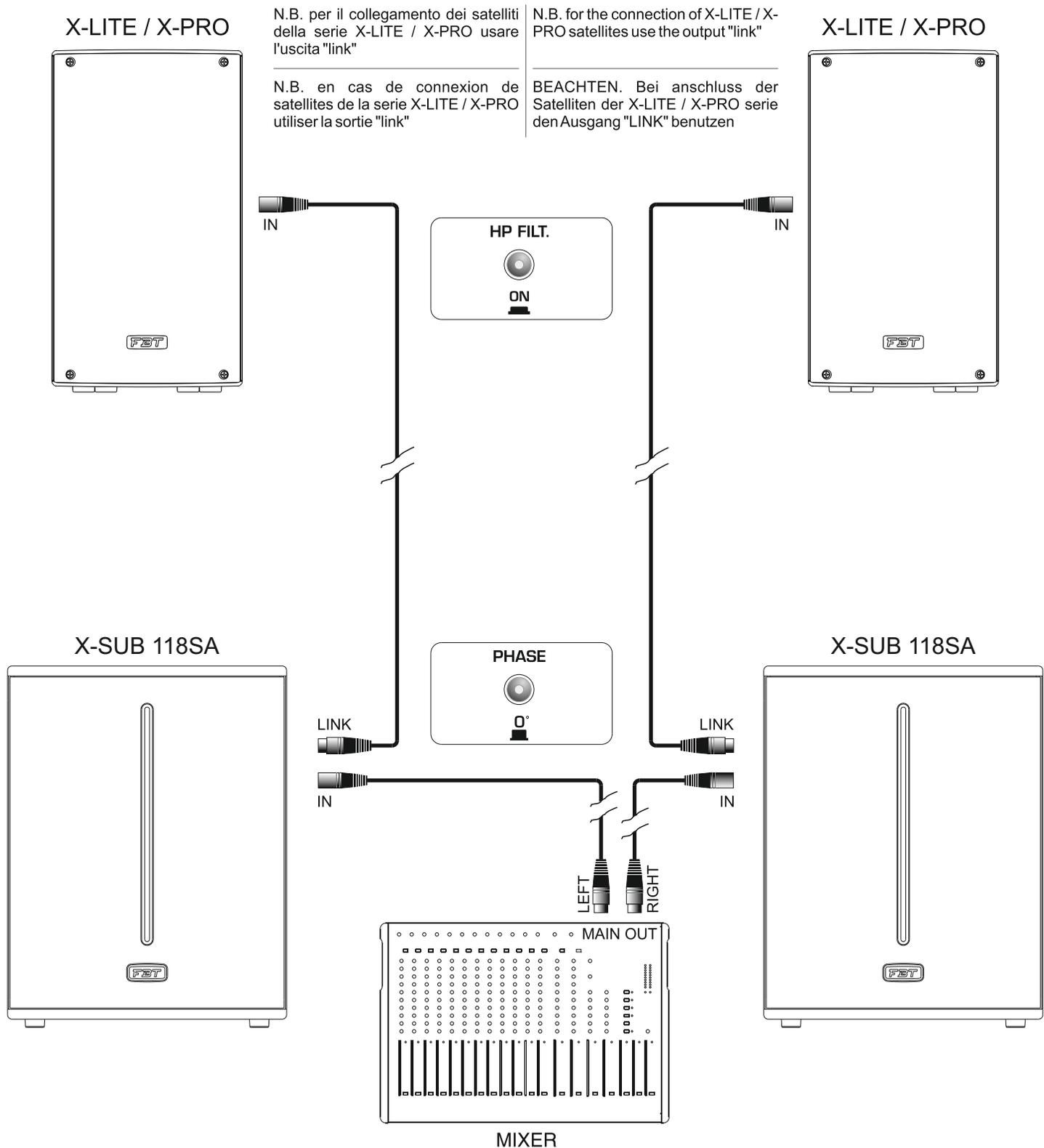
N.B. per il collegamento dei satelliti della serie X-LITE / X-PRO usare l'uscita "link"
