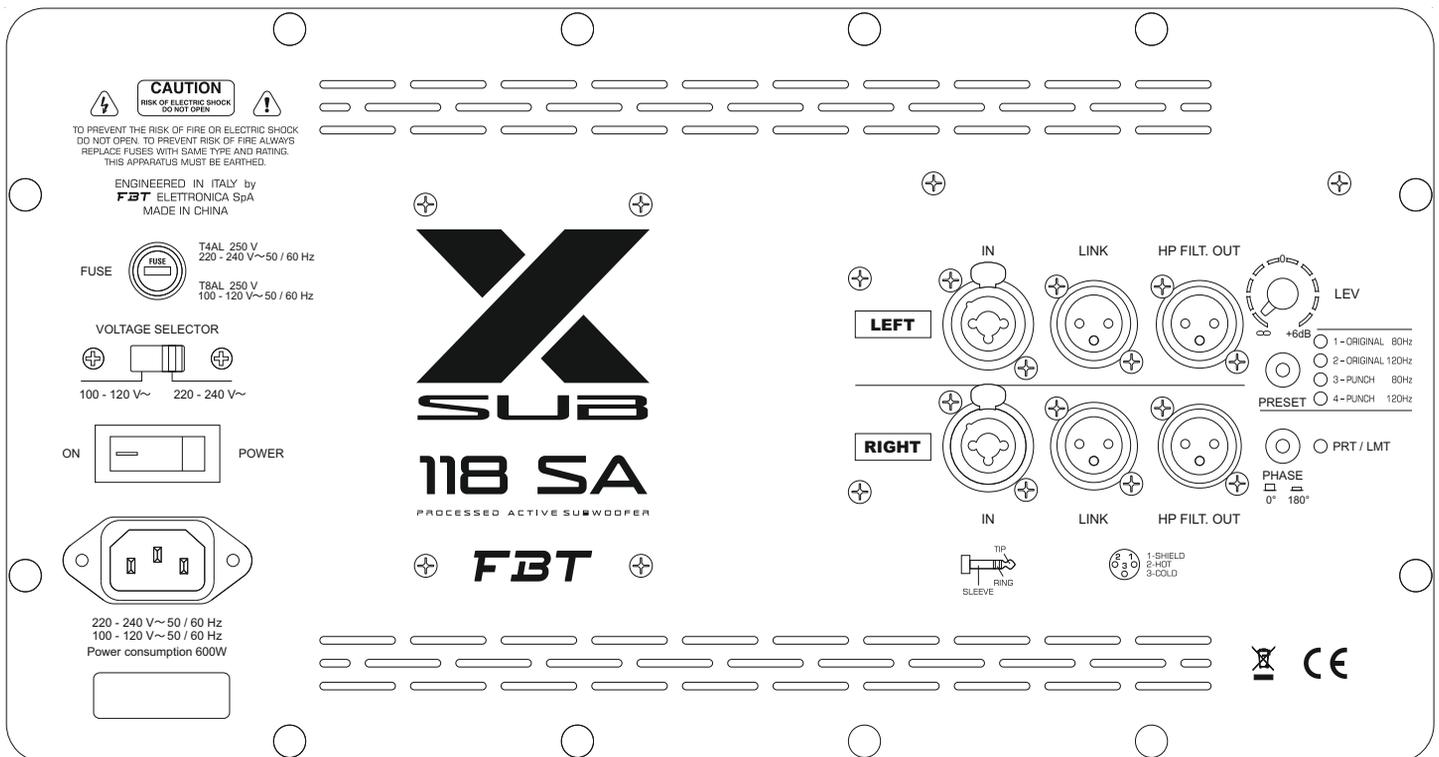
**IN / LINK:** prese di ingresso/uscita bilanciate collegate in parallelo; "IN" consente il collegamento di un segnale preamplificato come, ad esempio, quello in uscita da un mixer. "LINK" permette il collegamento di più diffusori con lo stesso segnale.
