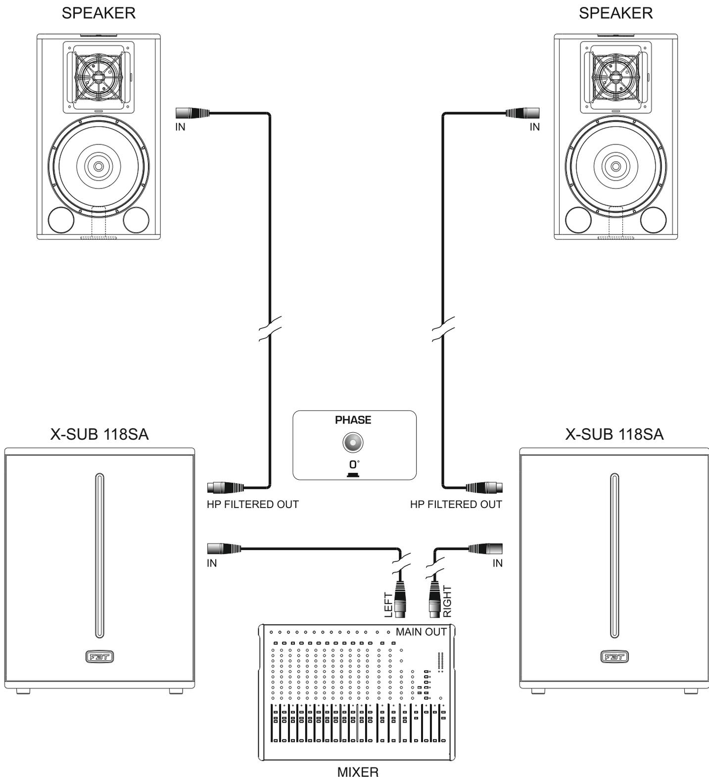
Usando l'uscita FILTERED OUT le basse frequenze vengono riprodotte solo dal Sub e si ottiene la massima qualità del suono; in questo caso posizionare l'interruttore PHASE in modo 0°.
