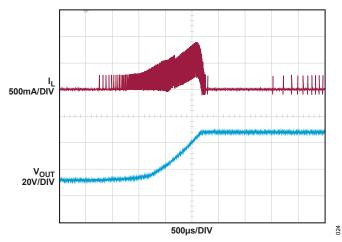
Figure 25. Soft-Start Waveforms
