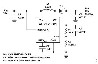
Figure 30. 48V Boost Converter
