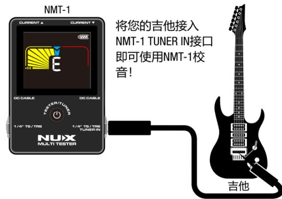
将您的吉他接入NMT-1 TUNER IN接口即可使用NMT-1校音！
