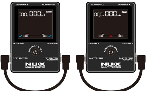
如果线材连通良好，屏幕显示“✓”，如上图所示。如果线材连通异常，屏幕显示“✗”，如上图所示。
