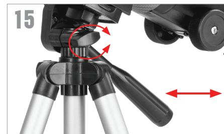
Pour orienter le télescope vers la droite et la gauche, tenez un pied du trépied d'une main, et de l'autre, utilisez la poignée d'orientation pour déplacer le télescope. La vis de verrouillage d'azimut peut être desserrée ou serrée pour régler la résistance comme désiré.
