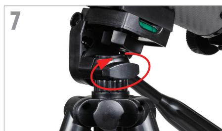
Gire la plataforma de montaje de forma que quede horizontal y apriete el mando para asegurarlo.
