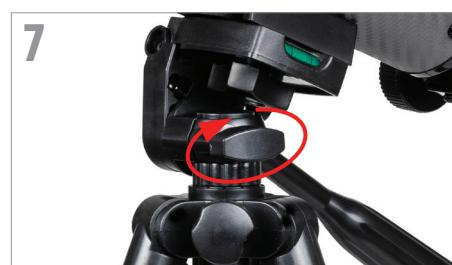
Ruotare la piattaforma di montaggio in modo che sia orizzontale e stringere la manopola per assicurarla.
