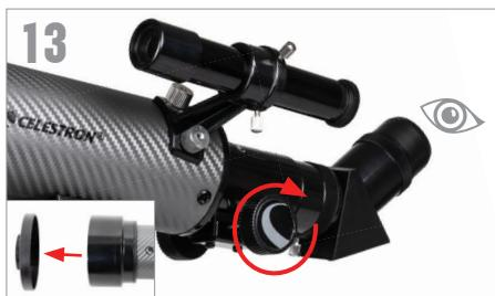
Retirez le capuchon de la lentille de l'avant du télescope. Lorsque vous observez, regardez dans l'oculaire comme illustré. Faites le point sur l'image en faisant tourner les molettes sous le système de mise au point.
