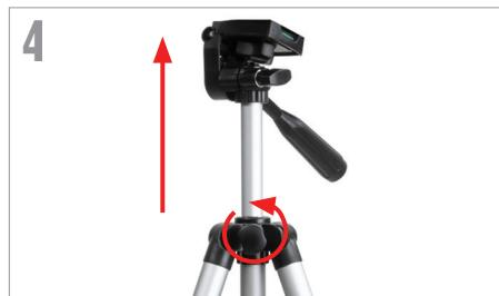
Para extender la columna central del trípode, gire en sentido contrario a las agujas del reloj el mando de bloqueo, levante en cabezal del trípode hasta que esté a la altura deseada y gire el mando de bloqueo en sentido de las agujas del reloj para asegurarlo.
