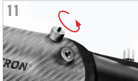
Saque las roscas estriadas de los postes estriados del extremo del enfoque del tubo telescopico.
