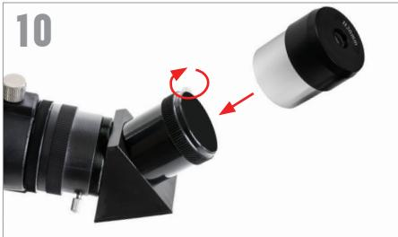
Introduzca el cañón del ocular de 20mm en la diagonal y apriete el tornillo.
