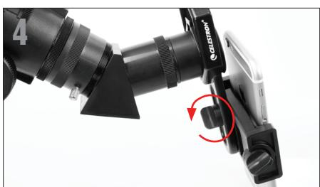
Lösen Sie den Knopf auf der Unterseite des Adapters, mit dem die Telefonklammer an der Okularklemme befestigt ist. Schieben Sie die Telefonklammer nach oben und unten und drehen Sie sie nach links und rechts, bis Ihre Kamera durch das Okular des Teleskops nach unten schaut. Ziehen Sie den Knopf auf der Unterseite des Adapters fest, um ihn zu sichern.
