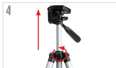
Per estendere il montante centrale del treppiedi, ruotare la manopola di blocco in senso antiorario, sollevare la testa del treppiedi fino all'altezza desiderata e ruotare la manopola di blocco in senso orario per assicurare.
