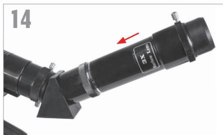
Sie können für eine zusätzliche Vergrößerung die mitgelieferte 3-fach Barlowlinse verwenden. Stecken Sie die Barowlinsen zwischen Zenitspiegel und Okular.
