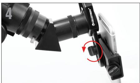
Afloje el mando de la parte inferior del adaptador que asegura la fijación del teléfono a la fijación del ocular. Deslice la fijación del teléfono arriba y abajo y gírela a izquierda y derecha hasta que la cámara esté mirando por el ocular del telescopio. Apriete el mando de la parte inferior del adaptador asegurarlo en posición.
