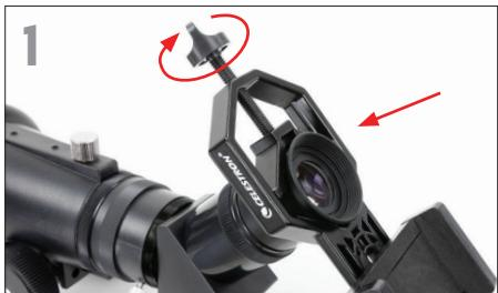
Aprire il morsetto dell'oculare e porlo intorno al corpo dell'oculare. Stringere il morsetto fino a quando non è sicuro.
