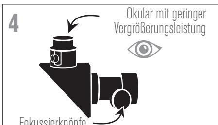
Schauen Sie durch das 20-mm-Ocular des Teleskops. Drehen Sie die Fokussierknöpfe langsam, um das Bild scharfzustellen.
