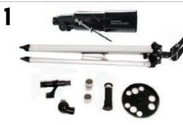
Déballez votre télescope, et vérifiez que toutes les pièces sont présentes. Votre PowerSeeker 80AZS est livré avec : un tube optique avec deux boulons de monture filetés, un trépied avec un support central, deux oculaires, une lentille de Barlow, un chercheur, un renvoi coudé et un plateau à accessoires.
