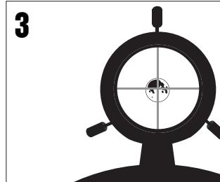
Regardez dans le chercheur et localisez le réticule. Continuez à orienter le télescope jusqu'à ce que le réticule soit superposé sur la Lune.
