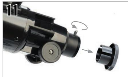
Afloje los tornillos del enfoque de forma que no obstruyan el diámetro interno del enfoque. Saque la tapa de plástico que cubre el extremo del enfoque.
