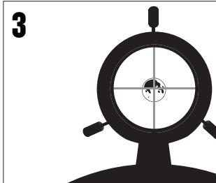
Osservare attraverso il cercatore e localizzare il reticolo. Continuare a muovere il telescopio fino a quando il reticolo appare sulla Luna.
