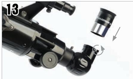
Introduzca el cañón del ocular de 20mm en la diagonal y apriete el tornillo, con cuidado de no apretarlo en exceso.
