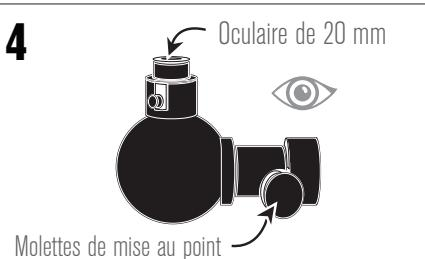
Regardez dans l'oculaire de 20 mm dans le télescope. Faites tourner doucement la molette de mise au point pour ajuster la netteté de l'image.
