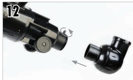
Localice la diagonal y saque las tapas de plástico. Introduzca el cañón de la diagonal en el enfoque y asegúrelo en posición apretando los tornillos.
