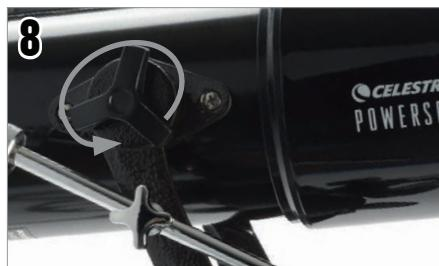
Alinee el tubo con los agujeros del soporte y asegure el tubo al soporte con los dos pernos de montaje estriados. Apriete para fijarlo en posición.
