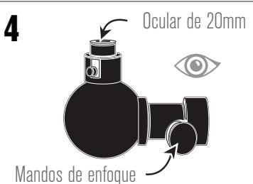
Mire por el ocular de 20mm del telescopio. Gire suavemente los mandos de enfoque para ajustar la definición de la imagen.
