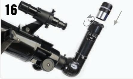
Poi, inserire il cilindro dell'oculare da 20 mm nel Barlow e stringere la vite per assicurarlo in posizione.
