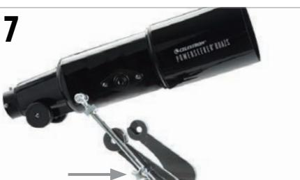
Individuare il tubo ottico e inserire l'asta di controllo dello slow motion nel foro sul supporto.
