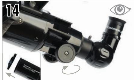
Rimuovere il tappo della lente dalla parte anteriore del telescopio. Per osservare, guardare attraverso l'oculare come mostrato sopra. Mettere a fuoco l'immagine ruotando le manopole al di sotto del focheeggiatore.
