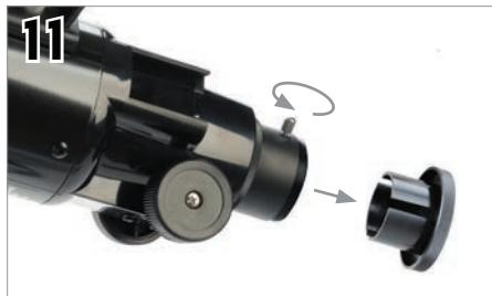
Allentare le viti sul focalizzatore in modo che non ostruiscano il diametro interno del focalizzatore. Rimuovere il tappo di plastica che copre l'estremità del focalizzatore.
