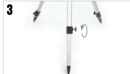
Den mittleren Teil jeder der drei Beinstreben ca. 15 bis 30 cm nach unten ausfahren. Die ausgezogenen Beine mit den drei Feststellschrauben unten an jedem Bein sichern.
