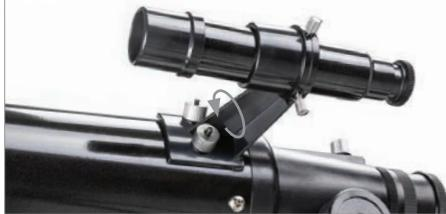
Localice el localizador y saque las tapas de plástico en la parte anterior y posterior de la lente. Oriente el localizador de forma que la lente más grande esté orientada a la parte anterior del tubo como se indica. Ponga el localizador sobre los postes del tubo y coloque las roscas estriadas para asegurarlo.
