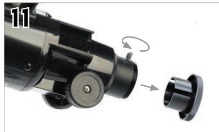
Desserrez les vis sur le système de mise au point, de manière à ce qu'elles ne pénètrent pas dans la surface interne du système de mise au point. Enlevez le capuchon en plastique qui couvre l'extrémité du porte-oculaire.
